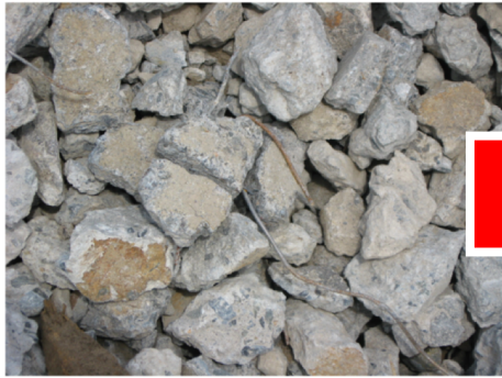
小割したコンクリート
